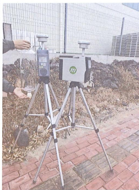
无组织废气下风向监控点 2#
