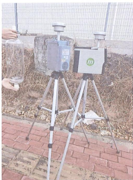
无组织废气下风向监控点 3#
