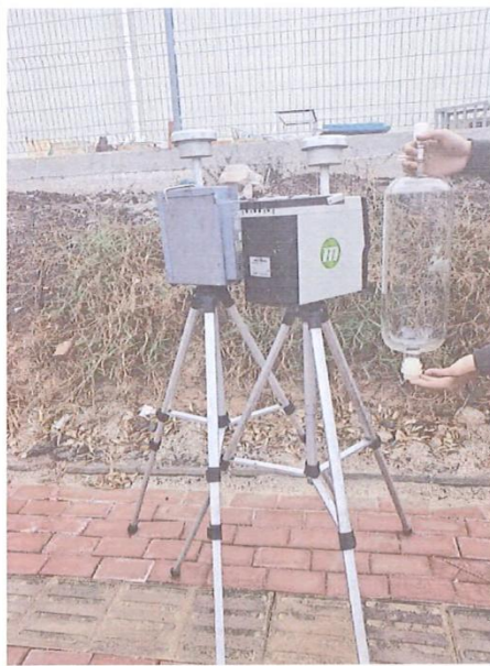
无组织废气下风向监控点 4#
