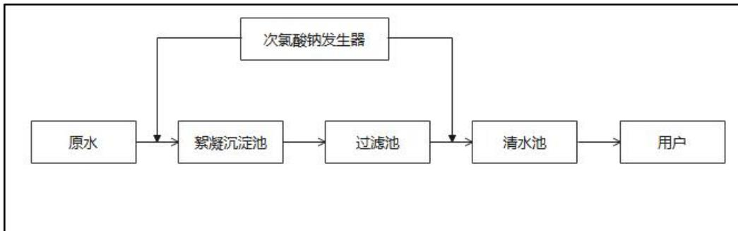
**图 2-1 自来水厂工艺流程图**
