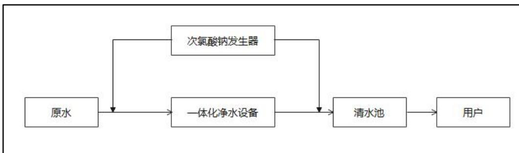
**图 2-2 供水站净水工艺流程图**
