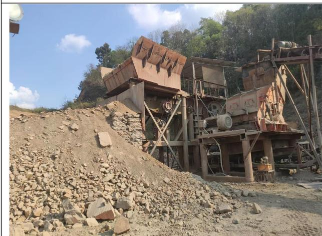
料斗机、鄂破机、反击破机围闭
